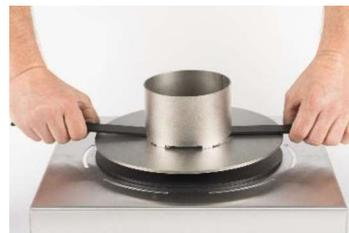
Die zwei Stangen werden als Deckelheber verwendet. Das Glasrohr kann stehen bleiben.
